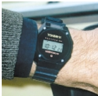
Носимая часть системы ТСКБМ, выполненная в виде наручных часов, контролирует состояние машиниста и передает информацию на бортовые устройства
