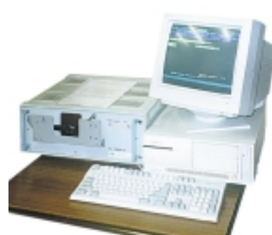
Стенд для проверки носимых частей системы ТСКБМ
