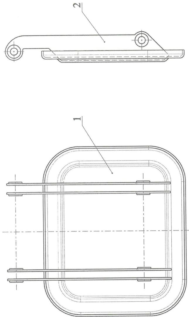
Рисунок А.13 - Крышка разгрузочного люка
